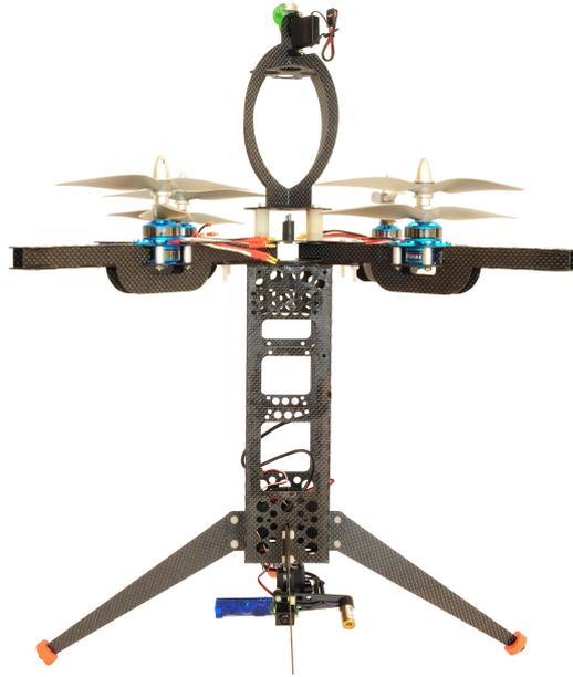
Figura 2.1: Un'immagine di un prototipo dei robot volanti presi come riferimento: gli eye-bot.
