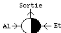
En activant la flèche *allumer* pendant un laps de temps, on passe d'un circuit stable à un autre circuit stable, ensuite allumer n'a plus d'action sur le circuit. De même pour éteindre, on active (pendant un laps de temps) la flèche *éteindre*.
